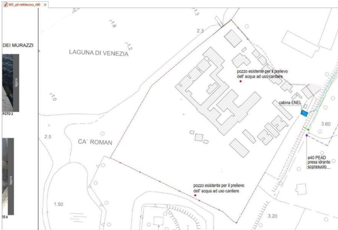
Figura 7: estratto dalla tavola di progetto t05, ubicazione dei pozzi da cui si vuole estrarre acqua per l'uso del cantiere
